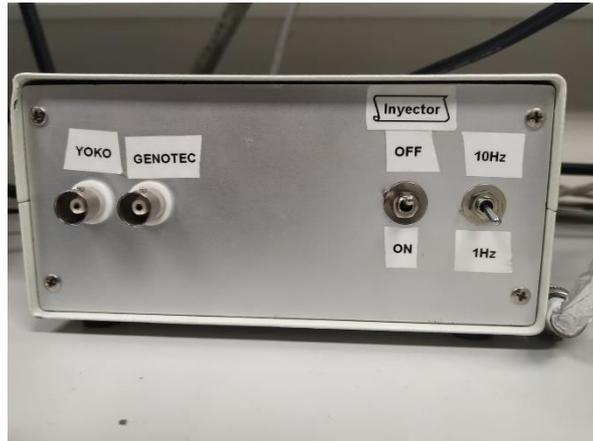
*Figura 3.9. Generador de señal.*
