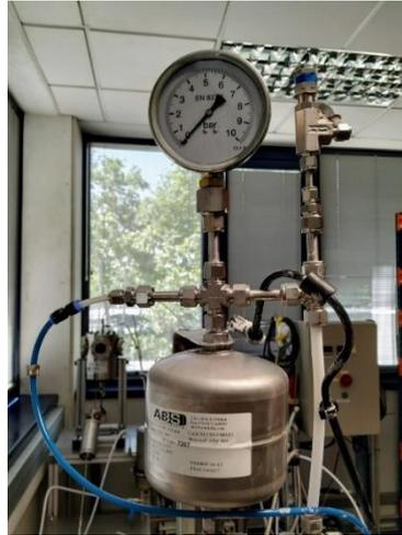
*Figura 3.4. Depósito de Urea y manómetro*
