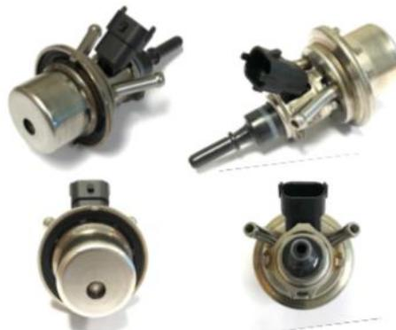
Figura 3.8. Inyectores de Urea adquiridos.
