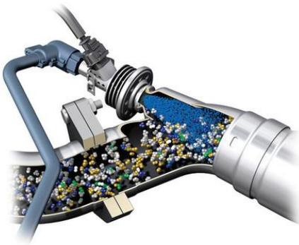
*Figura 2.12. Esquema inyector de urea con orientación axial al flujo [12].*
