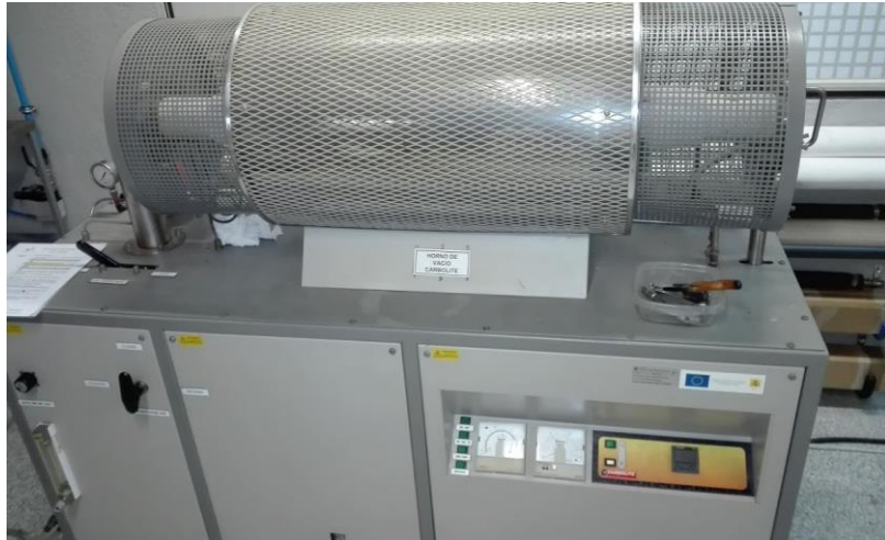
Figura 12. Horno de alto vacío de la casa Carbolite, modelo HVT 15-75-450, en el cual se llevó a cabo el proceso de sinterización de las aleaciones.
