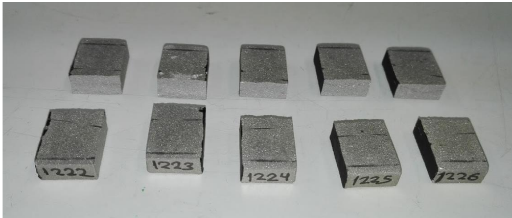
Figura 15. Mitades resultantes de someter al ensayo de flexión las probetas de la aleación Ti35Nb2Ag.
