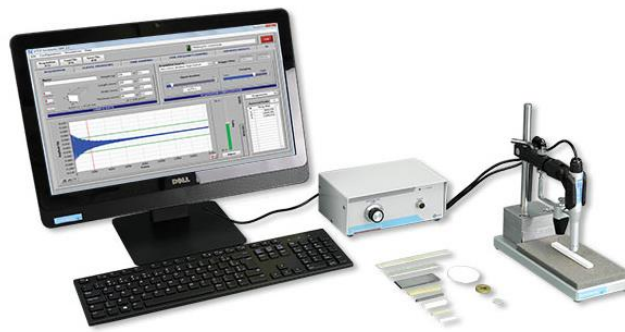
Figura 14. Equipo Sonelastic®, el cual cuenta con un soporte para las muestras, un percutor, un sensor acústico, y un ordenador para el procesamiento de las señales obtenidas.
