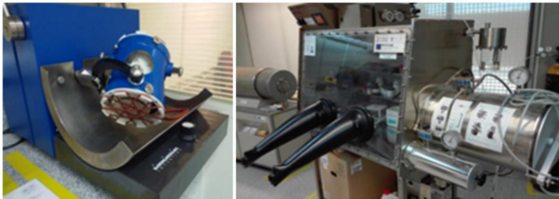
Figura 10. Túbula para la homogenización de las mezclas de polvos, a la izquierda. A la derecha, cámara de guantes con atmósfera controlada de argón.
