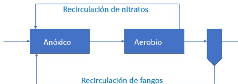
Figura 17: Esquema del proceso Ludzack-Ettinger para la eliminación biológica de nitrógeno. Fuente: Ferrer y Seco (2007).
