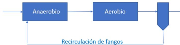
Figura 18: Esquema básico para la eliminación conjunta de materia orgánica y fósforo por vía biológica. Fuente: Ferrer y Seco (2007).
