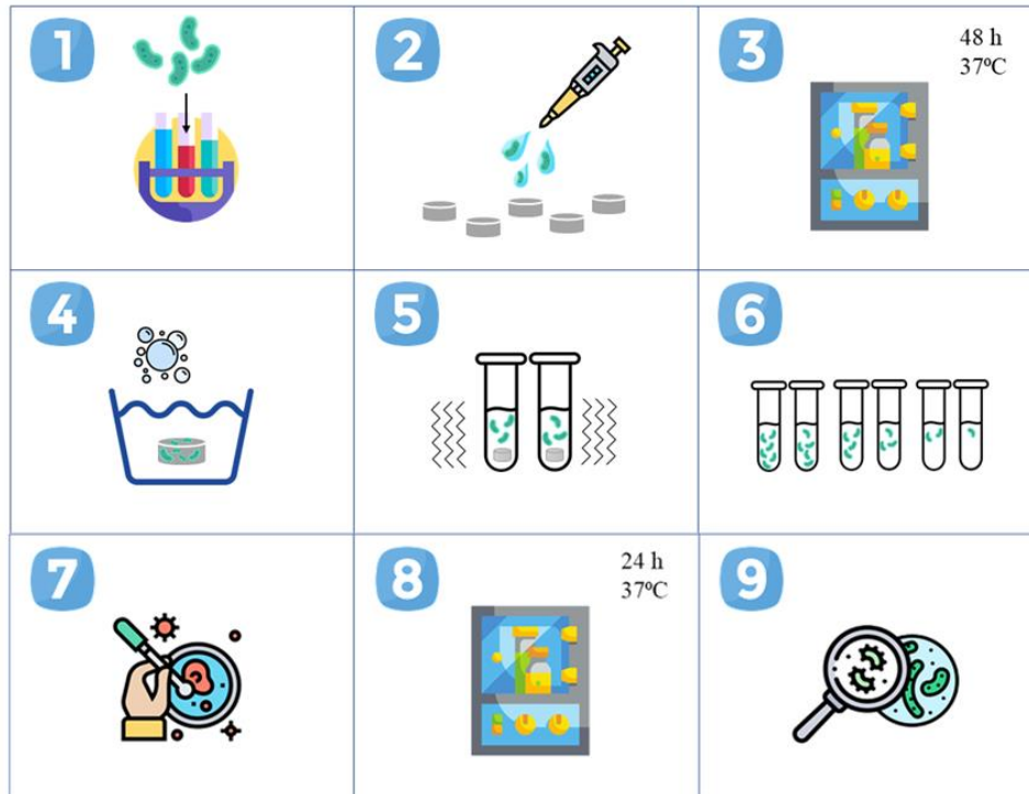
Figura 16. Pasos del ensayo de colonización (1: generación del inóculo, 2: inoculación de las muestras, 3: incubación, 4: limpieza de los discos y medio, 5: sonicación, 6: diluciones seriadas, 7: siembra en placa agar, 8: incubación y 9: conteo de UFC)
