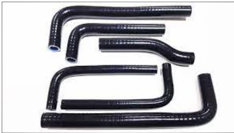
Ilustración 22. Manguitos o mangueras del sistema de refrigeración
