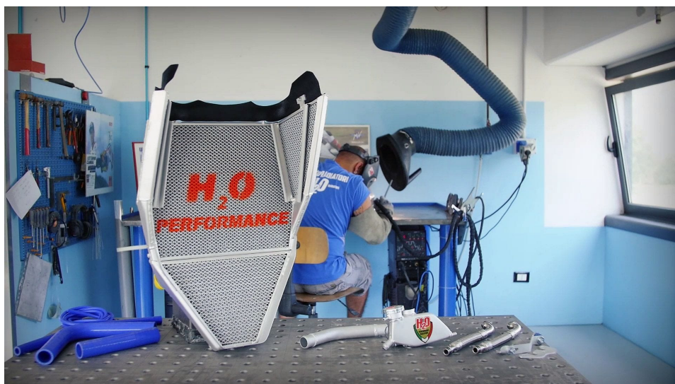
Ilustración 30. Radiador de motocicleta de competición con aletas
