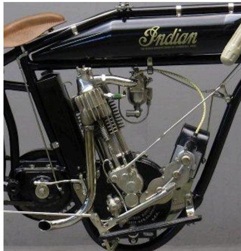
Ilustración 8. Motor Indian 1915 refrigerado por aire
