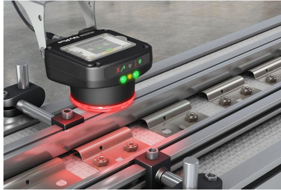
Figura 7. Cámara de visión artificial con inteligencia integrada realizando el reconocimiento de la colocación de las tuercas en una pieza.(Fuente: Visión Artificial Industrial (edsrobotics.com) )
