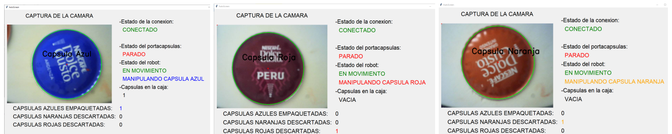
Figura 67. Reconocimiento de las cápsulas sobre el cabezal giratorio.(cápsula azul, roja y naranja etiquetadas)
