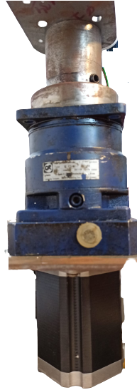
Figura 35. Conjunto de Reductor planetario 075-MF1-7-131-000 y motor de pasos NEMA 23 103H7823-5740
