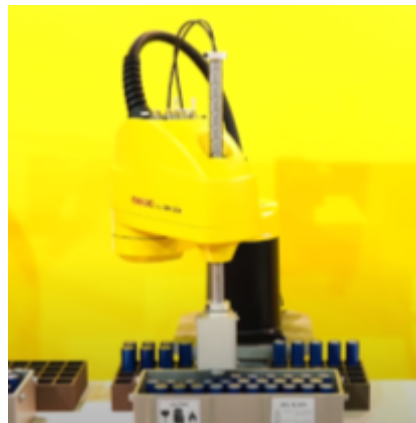
Figura 3. Robot scara Fanuc realizando pick and place de pilas(Fuente:(3) FANUC SCARA Robot )
