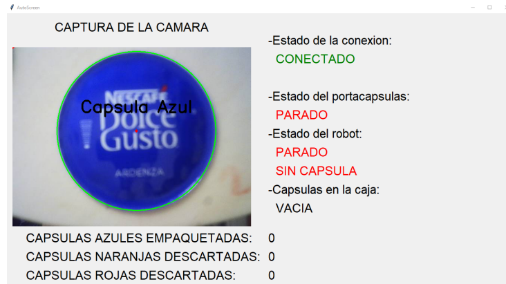
Figura 71. HMI del modo automático de funcionamiento.
