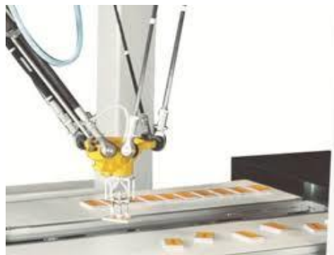
Figura 10. Robot delta manipulando azulejos. (Fuente: Robot delta (edsrobotics.com) )
