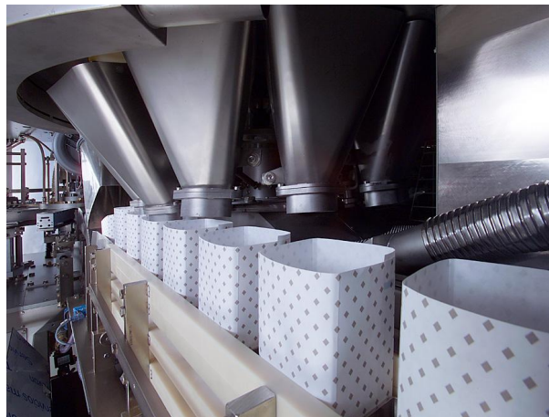
Figura 5. Máquina de empaquetado por peso Bosch empaquetando café.(Fuente: soluciones para envasado de café (imco.es) )
