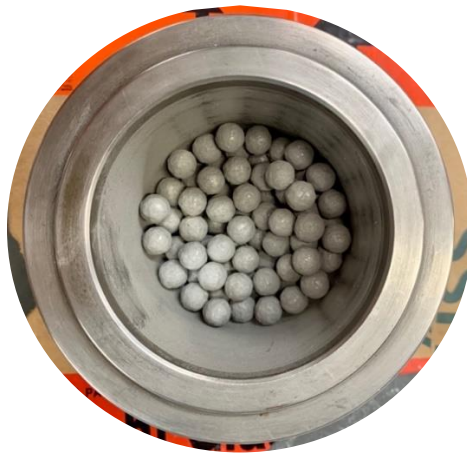
Figura 9. Ti-20Mg tras aleado mecánico, completamente pegado a las bolas.
