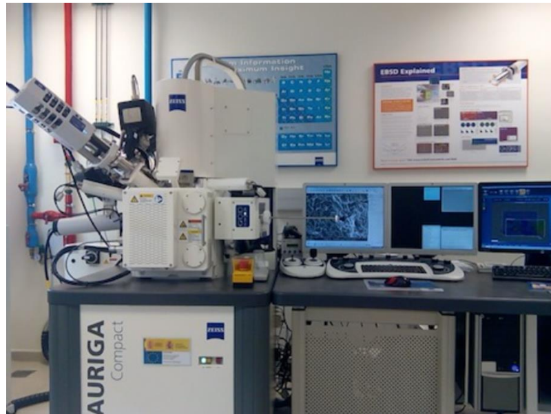
Figura 18. Microscopio de barrido electrónico de emisión de campo con cañón de iones focalizados (FIB) modelo AURIGA compact, de la marca ZEISS.
