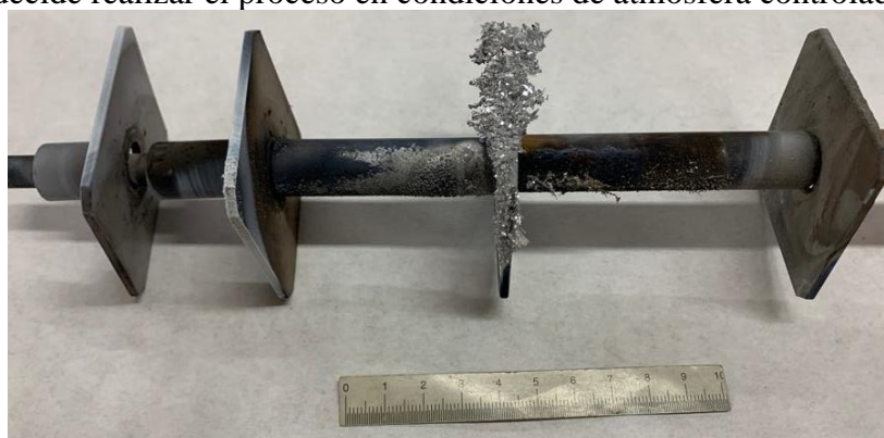
Figura 14. Mg sublimado pegado a la pared del difusor.
