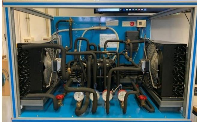
**Figura C3- 1:** *Equipo de bomba de calor del laboratorio (Figura de elaboración propia).*
