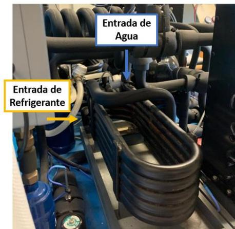
**Figura C2- 10:** Intercambiador de agua del equipo bomba de calor del laboratorio de Termodinámica Aplicada (Figura de elaboración propia).
