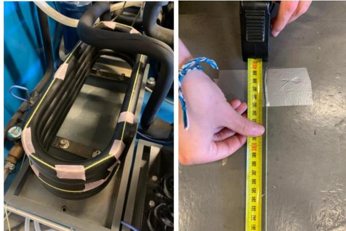
**Figura C4- 6:** Medición de la longitud de la tubería del intercambiador (Figura de elaboración propia).
