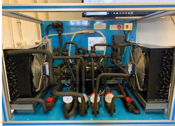
Figura C4- 7: Equipo de la bomba de calor tras el aislamiento (Figura de elaboración propia).
