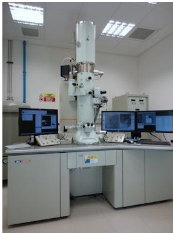
Fig. 25. TEM JEOL JEM 2100F ( Servicio de Microscopía Electrónica of the UPV ).
