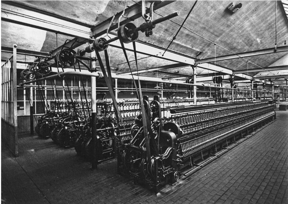
Figura 134. Máquinas de hilar accionadas por correas instaladas según el sistema Möbius (Leipzig, Alemania, hacia 1925). {[http://en.wikipedia.org/wiki/Line\\_shaft](http://en.wikipedia.org/wiki/Line_shaft)}.
