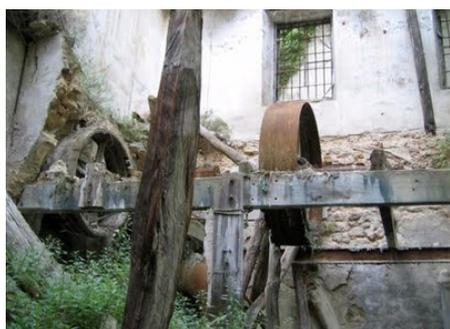
*Figura 17. Sistema hidráulico de transmisión de eje horizontal de un molino en el río Molinar de Alcoi (Fotografía propia. Julio 2012).*
