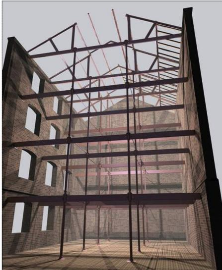
Figura 63. Detalles de la estructura original de la fábrica.
