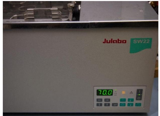
Ilustración 14. Baño termostático a 70°C
