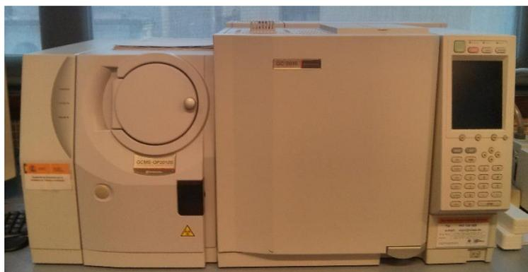
Ilustración 1 Cromatógrafo de gases-espectrómetro de masas GC-MS-QP2010S Shimadzu
