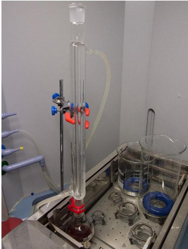
Ilustración 13. Ebullición con reflujo
