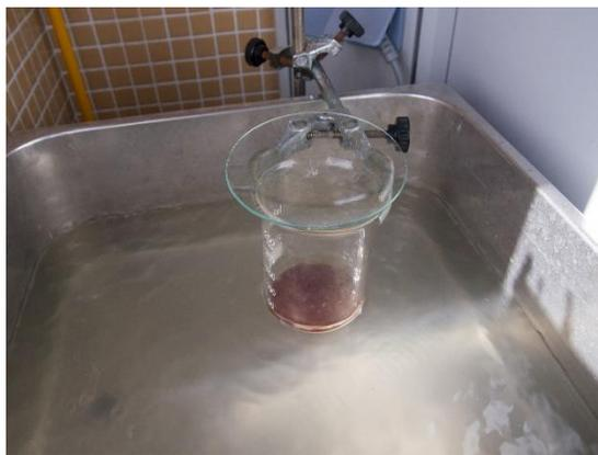
Ilustración 19. Recuperación extracto seco mediante ultrasonidos y metanol
