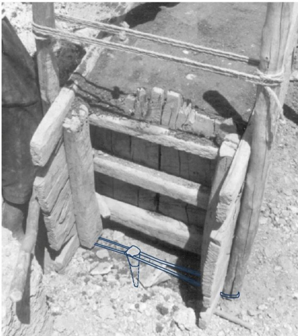
Sogueta atando la punta de los costales
