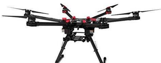
Fig. 13: Modelo multirrotor hexacóptero DJI Spreading Wings S900 Professional®
