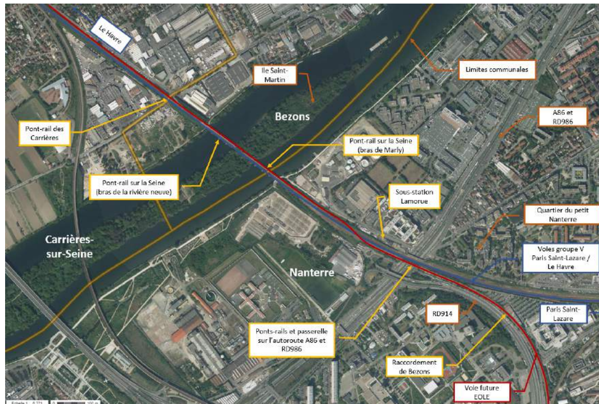
Figure 116 : Localisation du raccordement de la ligne existante avec la nouvelle infrastructure à Nanterre Source : SYSTRA
