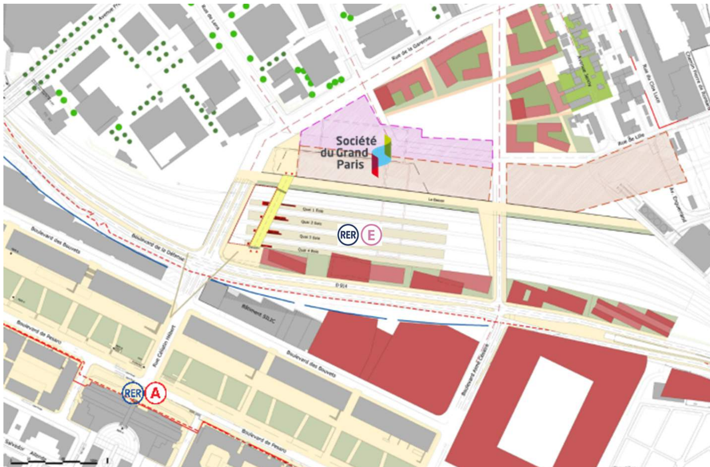
Figure 113 : Configuration envisagée de la gare : passerelle biaisée et accès sud en rez-de-chaussée d'immeuble Source : Obras & AREP
