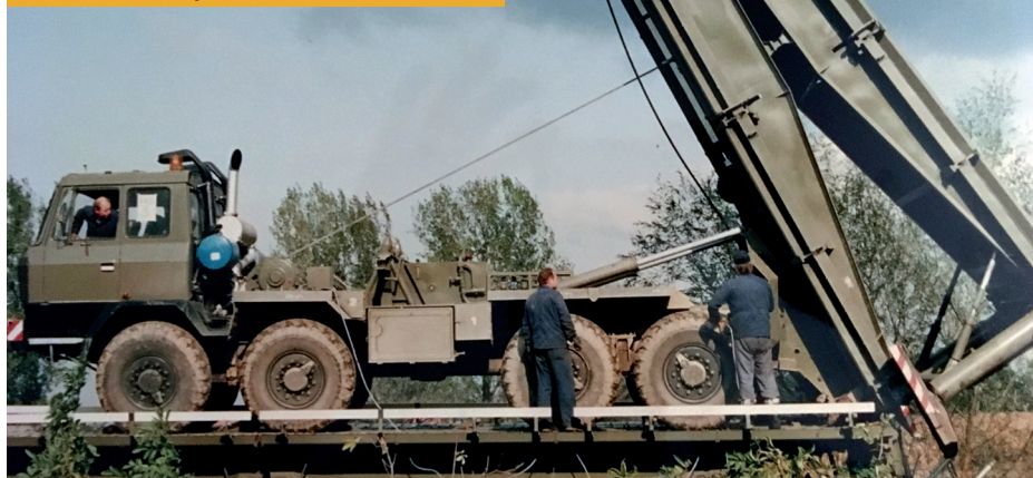
V Košiciach vyrábali i generáciu mostových automobilov AM 50 určených hlavne pre armádu
