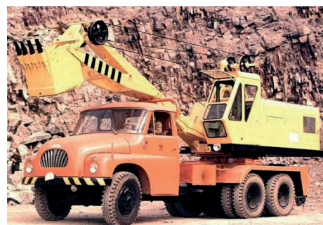
Podpolianske strojárne sa zameriavali na výrobu nakladačov a zemných strojov. Lanové rýpadlá pôvodnej konštrukcie boli postupne nahrádzané hydraulickými
