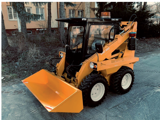
▲ Dodnes veľmi rozšírený šmykom riadený nakladač UNC 060 vyrábaný od roku 1981 v ZĽS Krupina. Na fotografii stroj v pôvodnom stave po precízne vykonanej renovácii (foto DETVA Industries)
