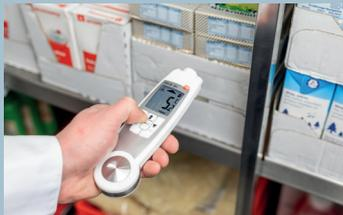
[▲]-Taste gedrückt halten und dabei die Laser auf Messobjekt ausrichten (2 Sek. ausreichend). Die Laserpunkte zeigen exakt die Grenzen des Messbereiches an. Daher immer beide Laserpunkte auf dem Messobjekt platzieren.
