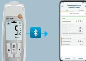
1. Mit der Taste wird der Messwert an die verbundene testo Smart App übertragen.
