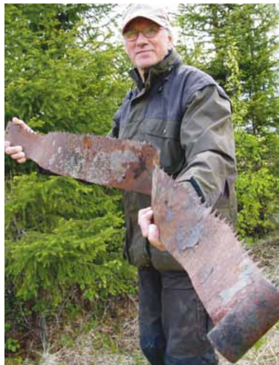
Tvåmanssågen var ett måste då timret var grovt. Med hjälp av höga bockar kunde man även klyvsåga stockar till plank och bräder.
