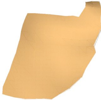
Figure 4 - Application d'un filtre de Taubin ( \lambda = 0.2 - \mu = 0.21 - N = 20 ) sur une nappe de marqueur – la nappe filtrée apparaît en rendu surfacique et la nappe originale en fil de fer.
