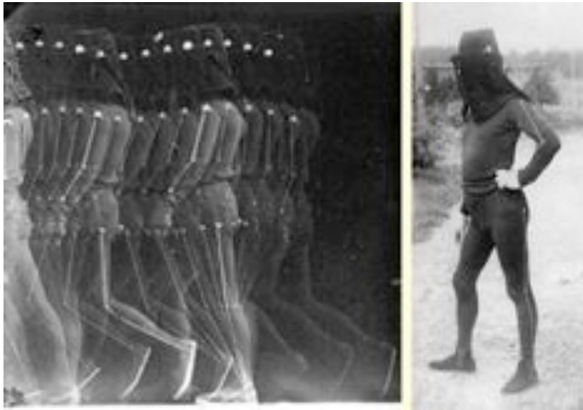
Figure 8 – Décomposition d'un mouvement par une série de clichés photographiques sur une même plaque (E.-J. Marrey).
