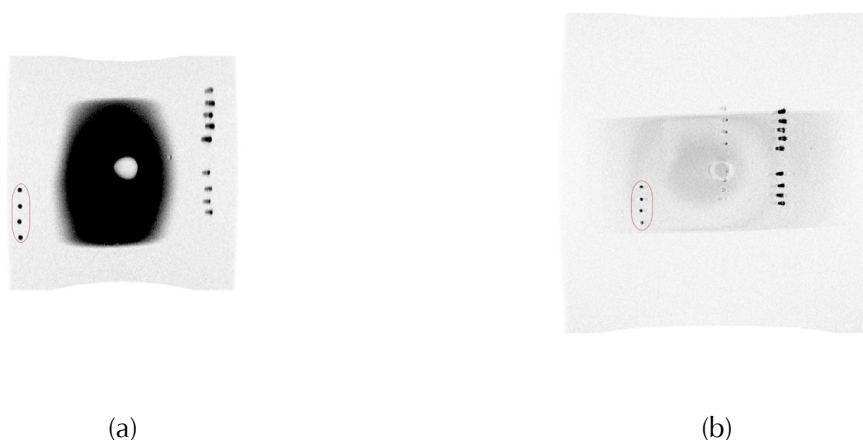
Figure 3 – Visibilité des bonbons “Hollywood Bulles Oxygen” dans les séquences – (a) Echo de spin Rho – (b) Echo de gradient T1
