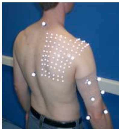
Figure 7 – Nappe de marqueurs d'environ 120 marqueurs sur l'omoplate
