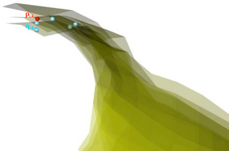
Figure 11 - Exemple de recherche des K-1 plus proches voisins d’un sommet – le point appelant du nuage mobile est en rouge et ses plus proches voisins sur les K-1 autres instances sont en bleu.
