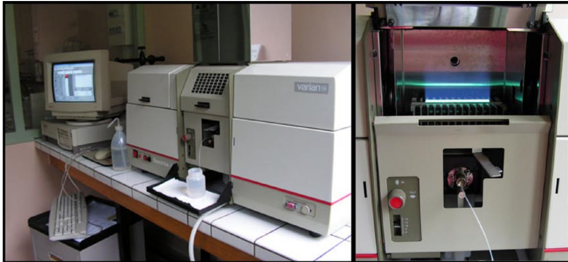
Figure 4a: Spectromètre de flamme utilisé pour la mesure du potassium
