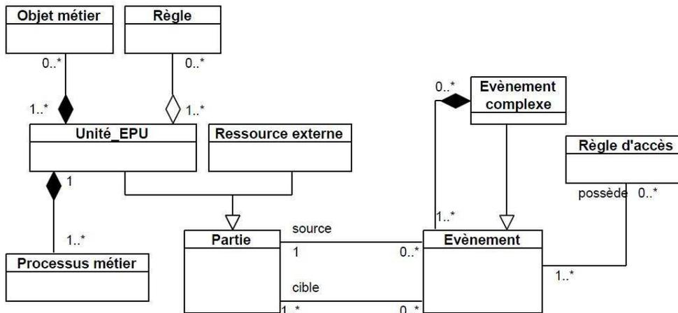
FIGURE 5.23 – Métamodèle du réseau détaillé de traitement d'évènements
