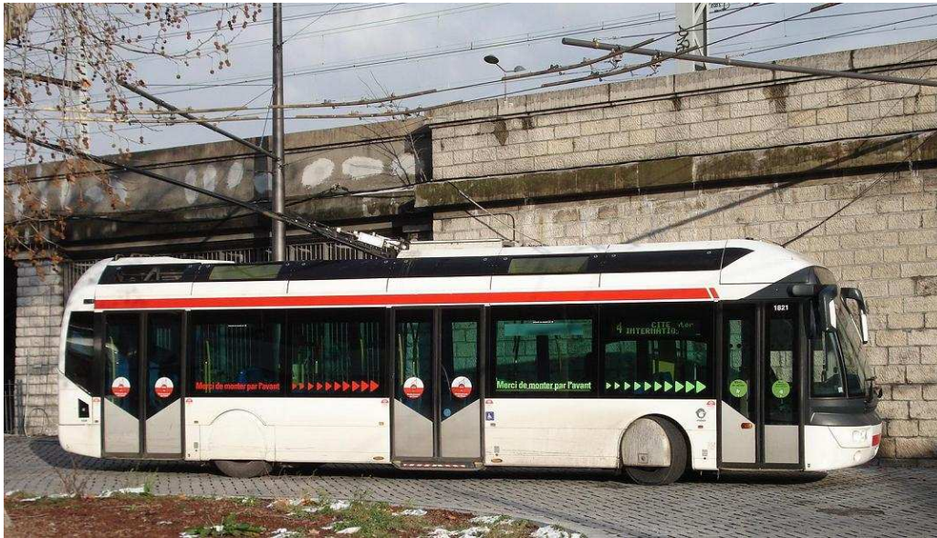
FIGURE 4.45 – Trolleybus Irisbus ETB12 avec ses perches déployées
