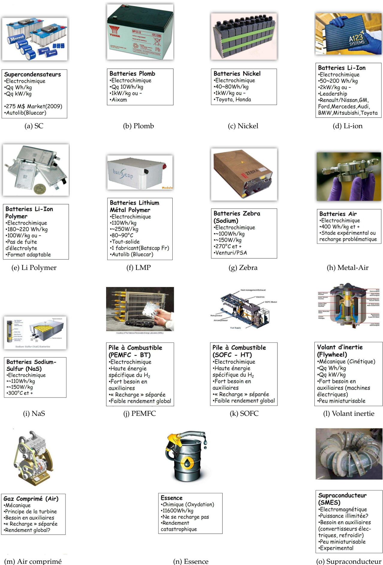
FIGURE 2.14 – Panorama des systèmes de stockage de l'énergie
