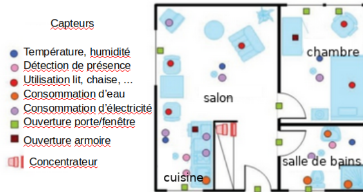
FIGURE 2.4 – GERHOME - plan montrant le positionnement des capteurs (Zouba et coll., 2009)
