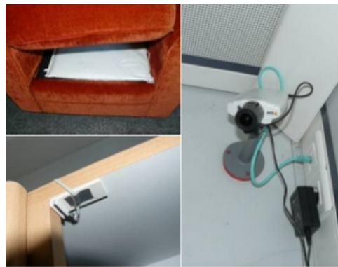
FIGURE 2.5 – GERHOME - instrumentation de l'habitat : capteurs, caméra et concentrateur (Zouba et coll., 2009)
