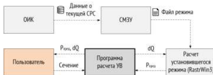
Рис. 1. Упрощенная структура алгоритма расчета управляющих воздействий
