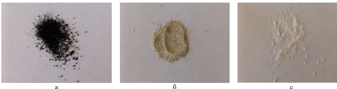
Рис. 1. Исследуемые твердые адсорбенты: а – уголь, б – богашевская глина, в – двуокись кремния
