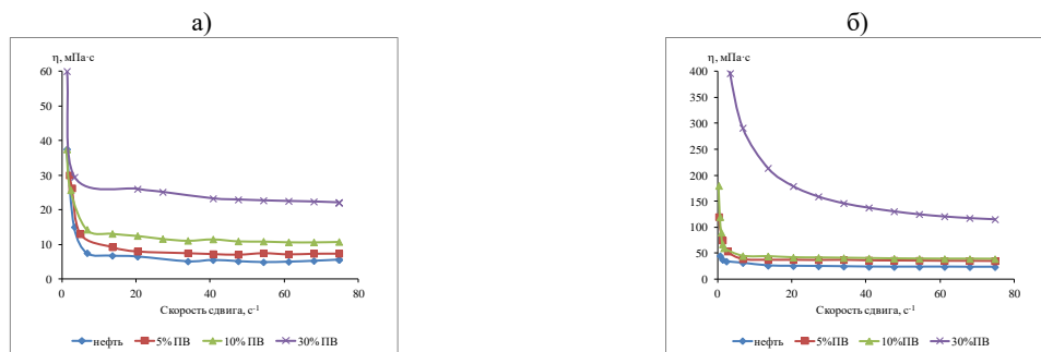
Рис. 1. Зависимости динамической вязкости \eta нефти и эмульсии с содержанием ПВ 5, 10, 30 % мас. Столбового (а) и Русского месторождений (б) от скорости сдвига при 20 °С
