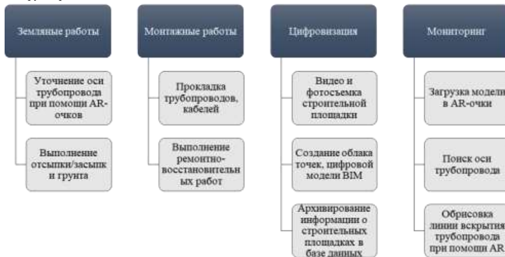
Рис. 1. Применение AR-технологий для контроля за безопасностью при земляных и монтажных работах
