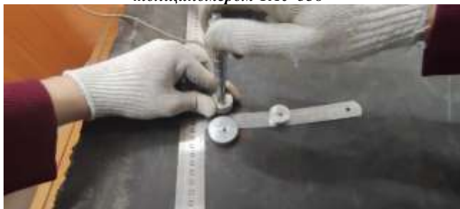
Рис. 3. Проведение твёрдометрии датчиком ударного действия с помощью твердомера МЕТ-УДА
