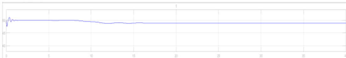
Рис. 1. Зависимость частоты от времени (высокая скорость открытия клапанов)
