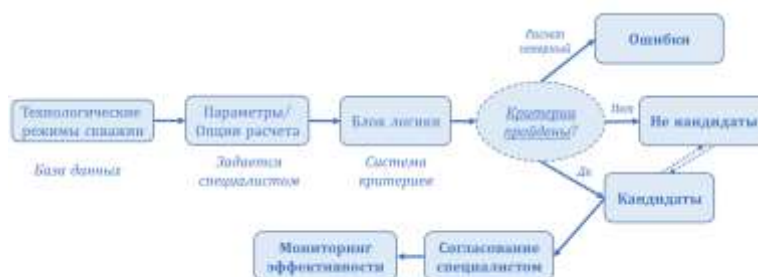
Рис. 3. Принципиальная схема интегрированного подхода к подбору ГТМ с учетом критериального отбора
