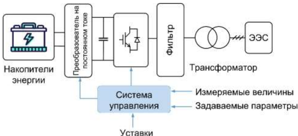
Рис. 1. Структура литий-ионной СНЭЭ
