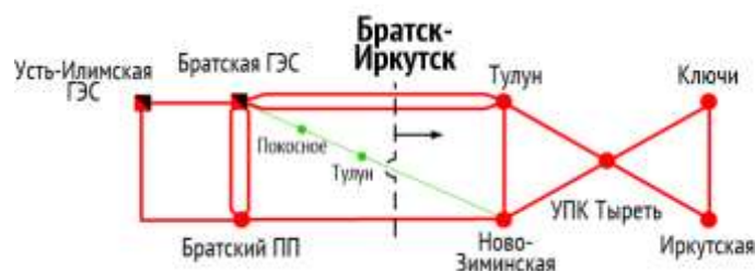
Рис. 2. Схема основных связей в энергорайоне контролируемого сечения «Братск — Иркутск»
