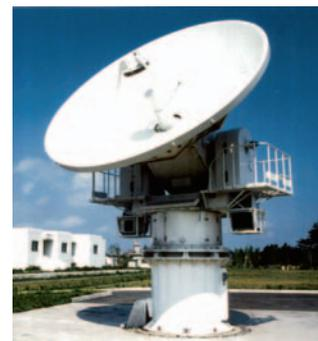
写真-3 鹿島26mアンテナを相手に, 日本各地でVLBI観測を行った可搬型5mVLBIアンテナ
