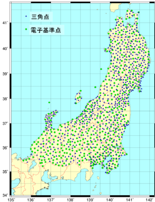
図-19 補正パラメータ構築に使用した電子基準点・三角点配点図
