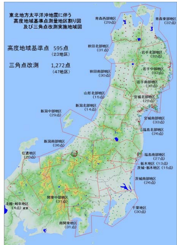
図-18 東北地方太平洋沖地震に伴う高度地域基準点測量及び三角点改測実施地域図
