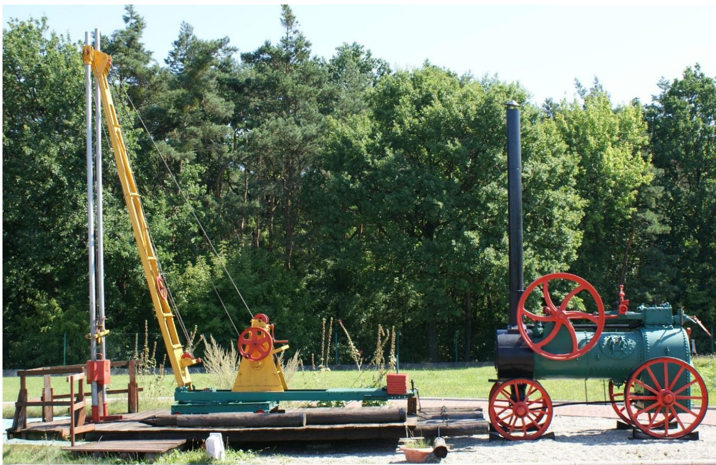
Zespół maszyn do wbijania bali pod konstrukcję mostową (kafar + lokomobila Ransomes, Sims & Jefferies) MD/T/140, MD/T/1
