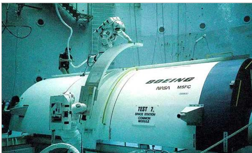
Simulador instalado en el Centro del Espacio Marshall cuyo escenario se encuentra reproducido por un tanque de flotación neutral dispuesto en una piscina de 22,5 m de diámetro y 12 m de profundidad. En esta plataforma los astronautas practican técnicas de construcción en el agua, un medio que imita la ingravidez del espacio
