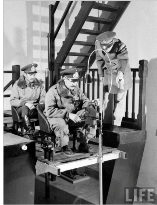
Simulador Vickers Bygrave. Diferentes posiciones del apuntador de bombardeo
