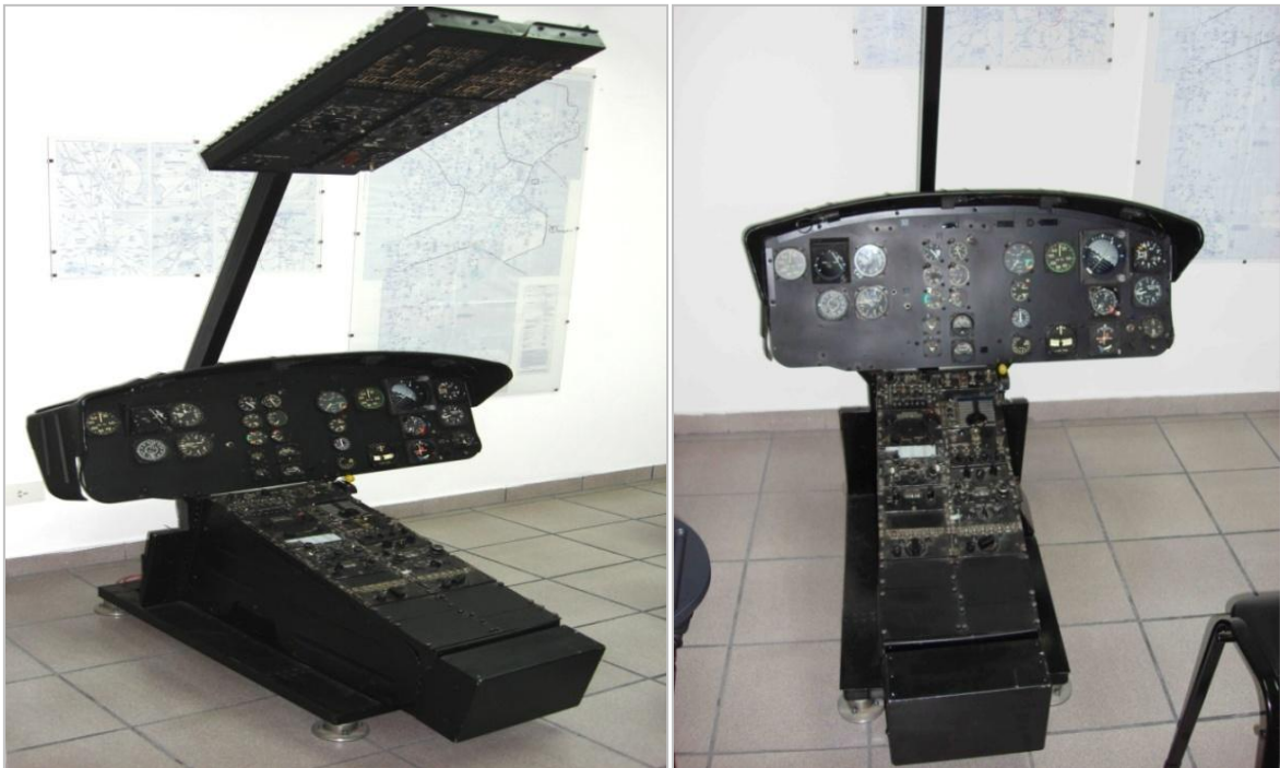
Mock-Up de helicóptero Bell UH-1H utilizado por la Escuela de Aviación del Ejército Argentino
