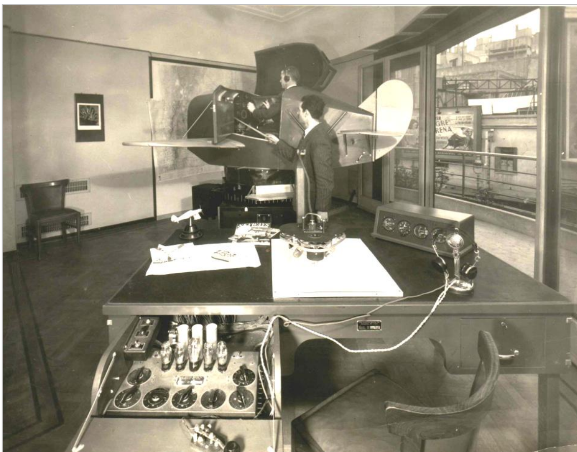
Entrenador Link E-1 que perteneciera al Ejército instalado en la empresa Cobaires
