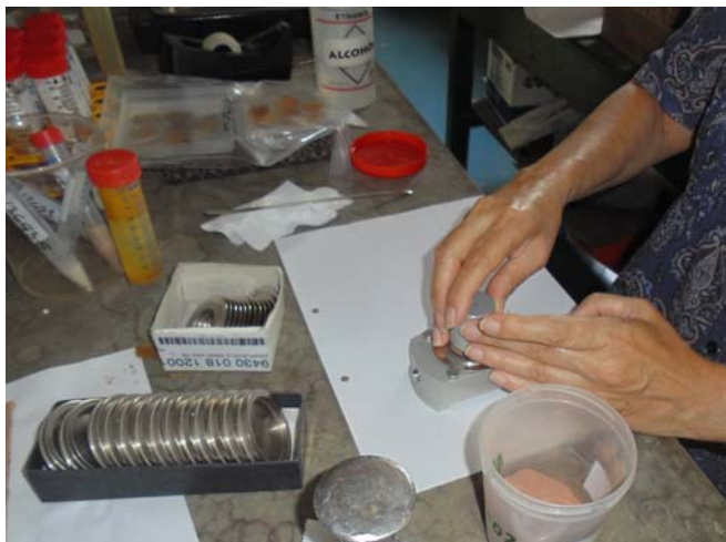
Preparación de muestras para analizar por RX.
