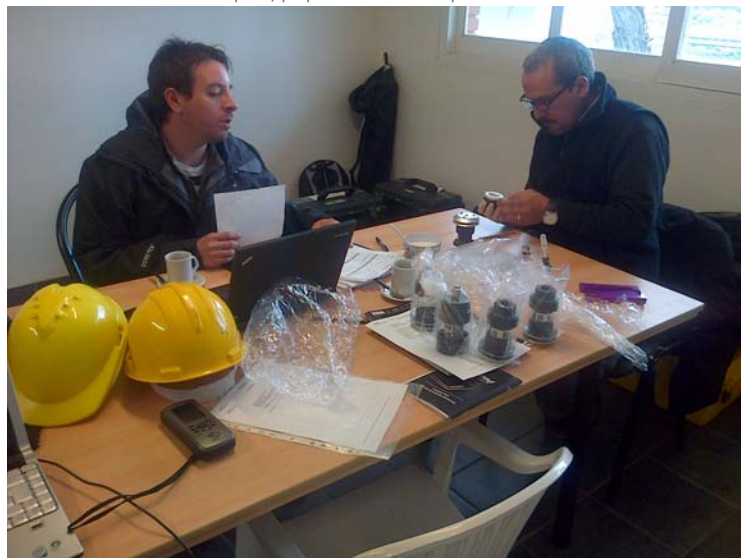
Laboratorio de Campaña, preparando cabezales para el monitoreo de la calidad del aire.
