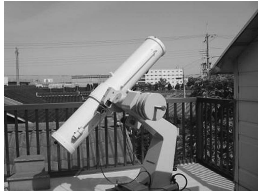
図5 自宅2階ベランダの超新星掃索用望遠鏡、口径26 cm反射赤道儀。
