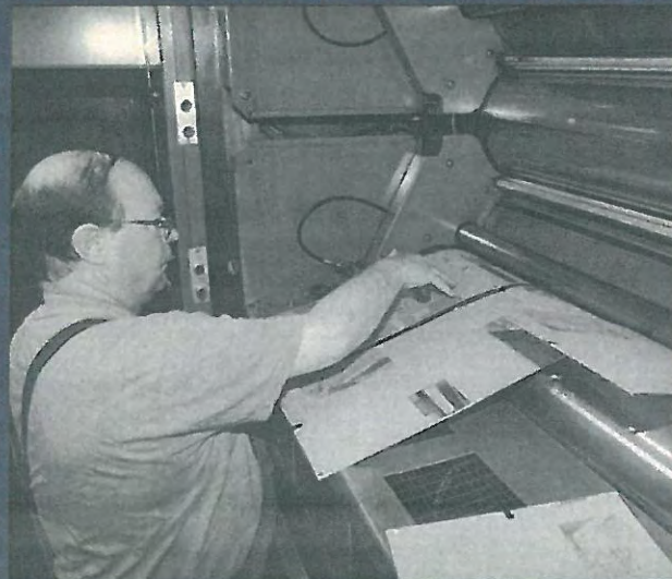
Drucker Heinz Leisibach spannt die Offsetplatten auf den Druckzylinder.
