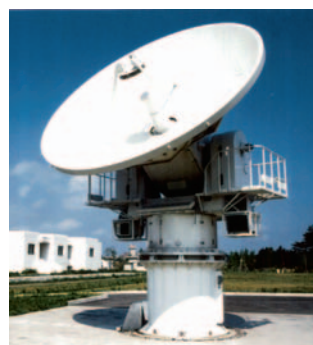
写真-3 鹿島26mアンテナを相手に, 日本各地でVLBI観測を行った可搬型5mVLBIアンテナ
