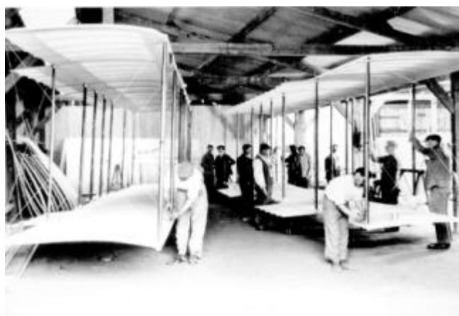
Usine Farman, entoilage des ailes. (Archives municipales de Boulogne-Billancourt).
