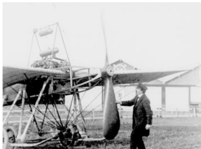
La firme Clément-Bayard présente au concours de Reims 1911 un très puissant monoplane à moteur Clerget 200 ch. (Collection M-H. Clerget).
