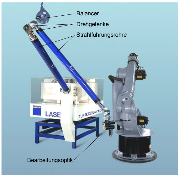
Bild 46: Robotergeführtes flexibles Strahlführungssystem mit 12 kW CO 2 -Laser (Quelle: Fa. TRUMPF).
