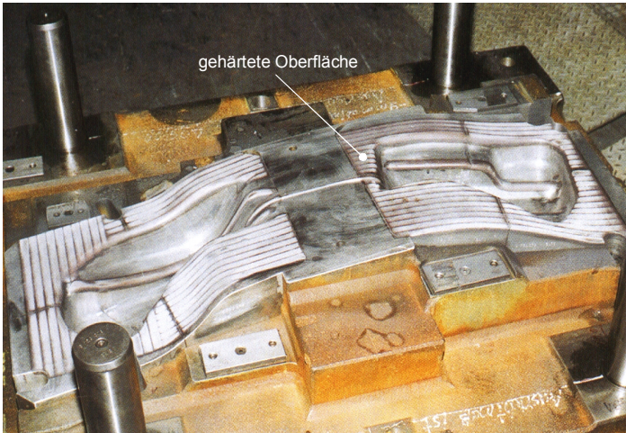
Bild 39: Matrize aus legiertem Grauguß mit lasergehärteter Formfläche (Quelle: MAN).
