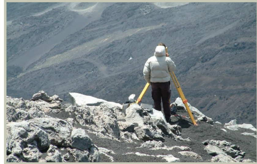
Medida de la deformación mediante un distanciómetro en el Etna (Italia). Foto R. Ortiz.
