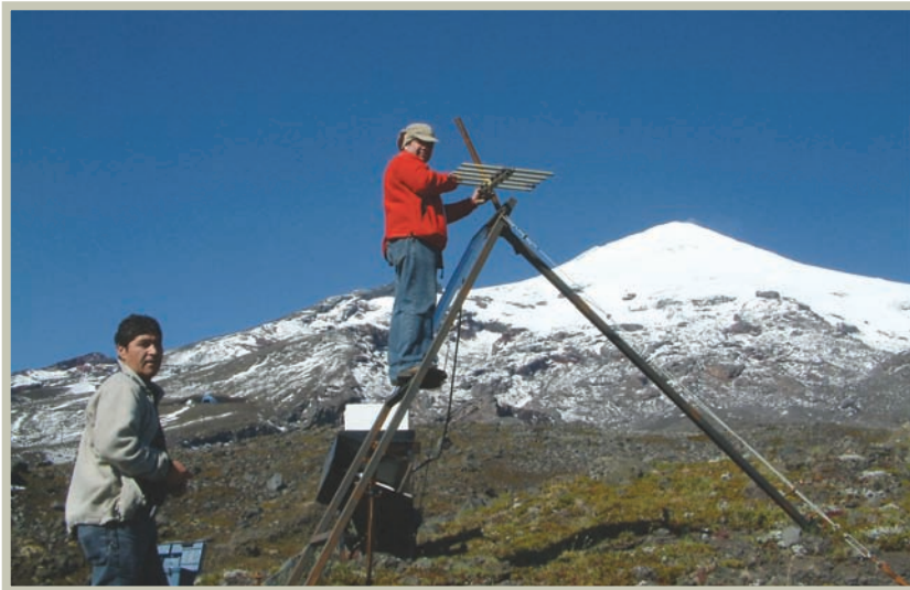
Colocación de una estación sísmica en la base del volcán Villarrica (Chile). Foto A. Llinares.
