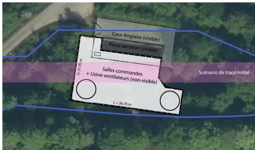
Figure 102. Impact de l'emprise de l'usine par la plateforme
