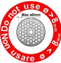
**⚠ ОПАСНОСТЬ - ВНИМАНИЕ:** Строго запрещается использовать решетки с отверстиями, диаметр которых превышает 8 мм, или толщиной меньше 5 мм. Обеспечить замену решетки, если в результате износа ее толщина станет меньше 5 мм. Производитель не несет какой-либо ответственности за любой вред, нанесенный людям или имуществу в результате несоблюдения указанных выше предписаний.
