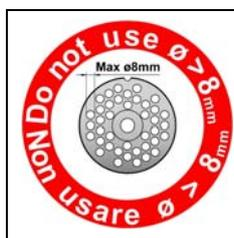
**⚠ DANGER – ATTENTION:** Il est formellement interdit d'utiliser des plaques présentant des trous de diamètre supérieur à 8mm et une épaisseur totale inférieure à 5mm. Il est recommandé de remplacer la plaque si l'usure engendre une épaisseur inférieure à 5mm. Le constructeur décline toute responsabilité pour tout dommage aux choses ou aux personnes dérivant de la non observation des susdites dispositions.
