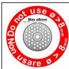
**⚠ GEFAHR – ACHTUNG:** Es ist strengstens verboten, Scheiben mit Löchern mit einem größeren Durchmesser als 8 mm und Scheiben mit einer Gesamtstärke von weniger als 5 mm zu verwenden. Wir empfehlen, die Scheibe auszuwechseln, wenn der Verschleiß eine Scheibenstärke von weniger als 5 mm verursacht. Der Hersteller übernimmt keinerlei Haftung für Schäden an Sachen oder Personen, die durch die Nichtbeachtung der oben genannten Anweisungen verursacht werden.
