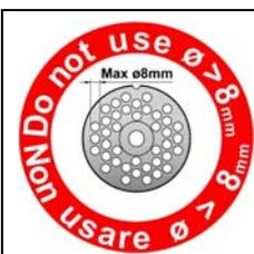
**⚠ PERIGO – ATENÇÃO:** É rigorosamente proibido utilizar discos com furos com um diâmetro maior de 8mm e uma espessura total inferior a 5mm. Recomenda-se a substituição do disco, quando, por desgaste, a sua espessura resulta inferior a 5mm. O construtor declina qualquer responsabilidade por qualquer dano a coisas ou a pessoas, provocados pela inobservância das referidas disposições.
