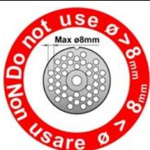
**⚠ PERICOLO – ATTENZIONE: E' severamente vietato utilizzare piastre con fori aventi un diametro maggiore di 8mm ed uno spessore totale inferiore a 5mm. Si raccomanda di sostituire la piastra, qualora l'usura determini uno spessore inferiore ai 5mm. Il costruttore declina ogni responsabilità per qualsiasi danno, a cose o persone, derivanti dall'inosservanza delle suddette disposizioni.**
