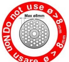
**⚠ PELIGRO - ATENCIÓN:** Queda terminantemente prohibido utilizar placas con orificios que presenten un diámetro mayor que 8 mm y un espesor total inferior a 5 mm. Se recomienda sustituir la placa en cuanto alcance un espesor inferior a 5 mm debido al uso. El constructor declina toda responsabilidad por cualquier daño, material o personal, derivado del incumplimiento de dichas disposiciones.
