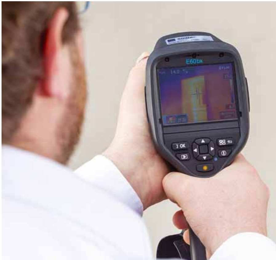
Les défauts d'isolation du bâtiment sont décelés à l'aide d'une caméra infrarouge.
