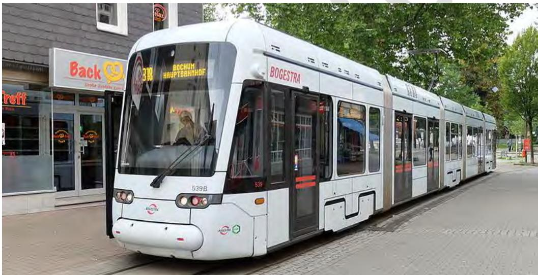
Abb. 3.3-12: Niederflurstraßenbahn der BOGESTRA im Meterspurbetrieb (Variobahn vom Hersteller Stadler)<sup>37</sup>
