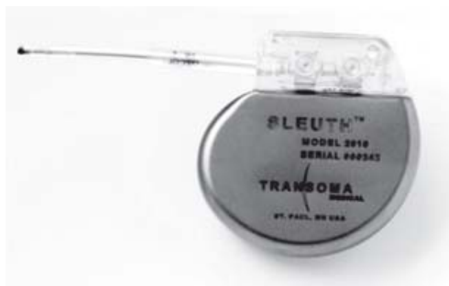
Figura 3. Grabadora implantable de eventos cardiacos. Dispositivo diseñado para grabar eventos cardiacos durante un episodio sincopal.
