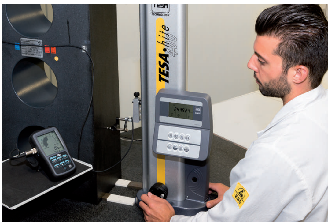
Misura della perpendicolarità con un tastatore induttivo ed il visualizzatore TWIN-T10
