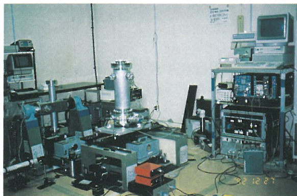
図2 重力計室内に設置された2台の絶対重力計
