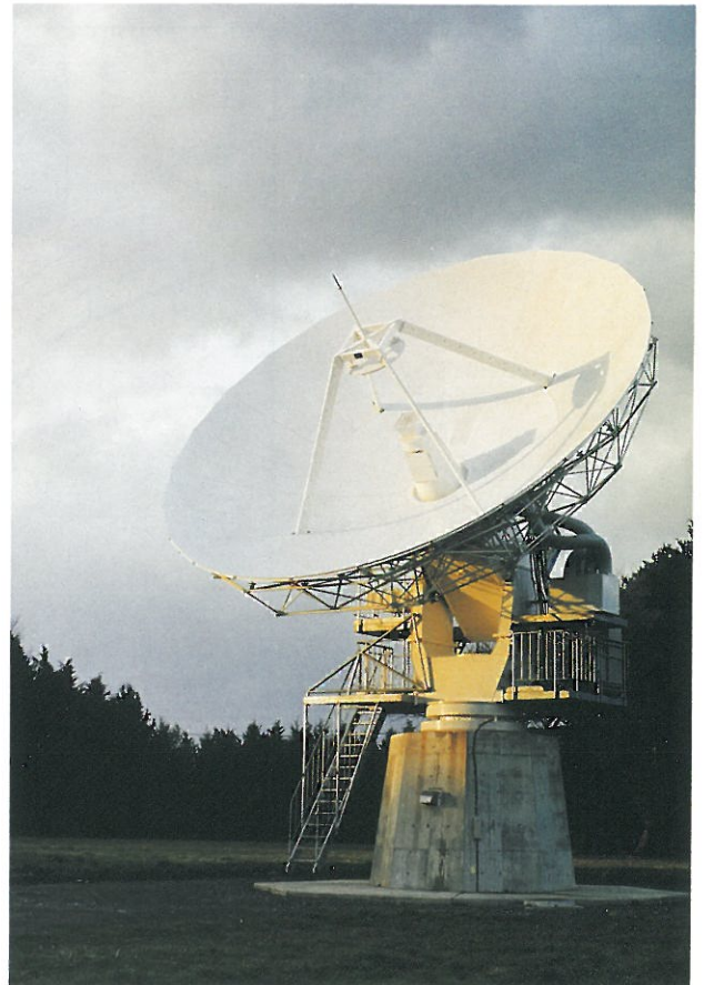
図1 水沢に建設された VLBI 用 10m アンテナ
