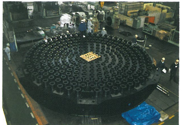
図3 完成した主鏡セル（川鉄鉄構水島工場）。
