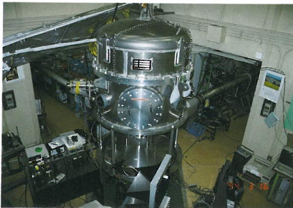
図1 レーザー干渉計の中心部 左下のレーザー光源部から光学窓を通して真空槽内の干渉計にレーザー光が照射される。
