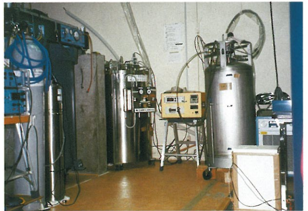
図2 重力計室内での超伝導重力計設置状況
