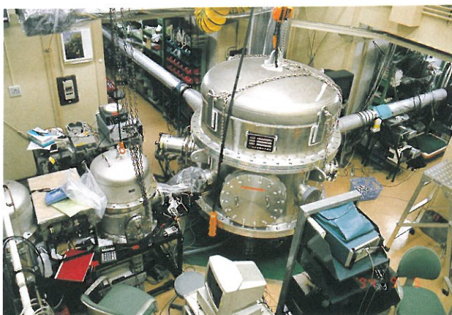
図1 モードクリーナーと干渉計中心部。モードクリーナー用の鏡が入った2つの真空槽（左側）と干渉計用中央真空槽および真空パイプの一部。
