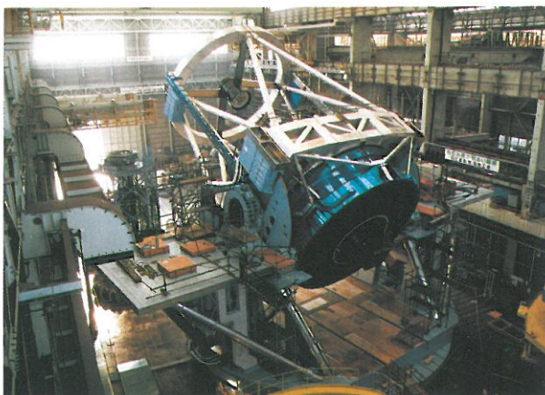
図1 全体構造が組み上げられたすばる望遠鏡の機械部分。8mの主鏡はスチールのダミーであるが、その他は主鏡能動支持のセルや駆動機構を含めて、ほとんどが実機である。この工場仮組みは、三菱電機の指導により日立造船桜島工場（大阪）で実施された。このあと解体・梱包されて、ハワイに送られる。左手前のナスミス台の上の人に注意。
