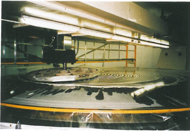
図2 ピッツバーグの地下工場で裏面研磨中の8m主鏡材。温度やダストなどの厳しい管理と、細心で忍耐強い作業が要求される。
