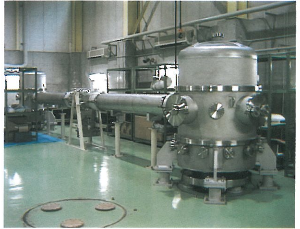
図 2 中央真空槽室内に設置された 10 m モードクリーナー用真空槽
