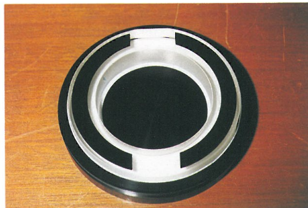
図1 FeXIV (211 Å) 輝線観測用のX線多層膜球面鏡(観測ロケット搭載用フライト鏡)。2つのセクターに反射波長が異なる多層膜がスパッターされている。波長分解能 \lambda/\Delta\lambda \sim 30 、反射率~20%、波長一様性~0.2%、絶対波長精度~1 Åと高性能のX線ミラーである。
