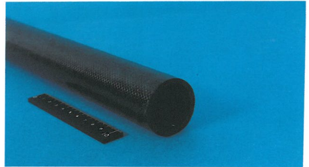
図 1 光学ベンチトラス構造用 CFRP 精密パイプの試作品。グラファイト・シアネード複合材料を使用して、ゼロ変形・ゼロ吸湿変形化されている。
