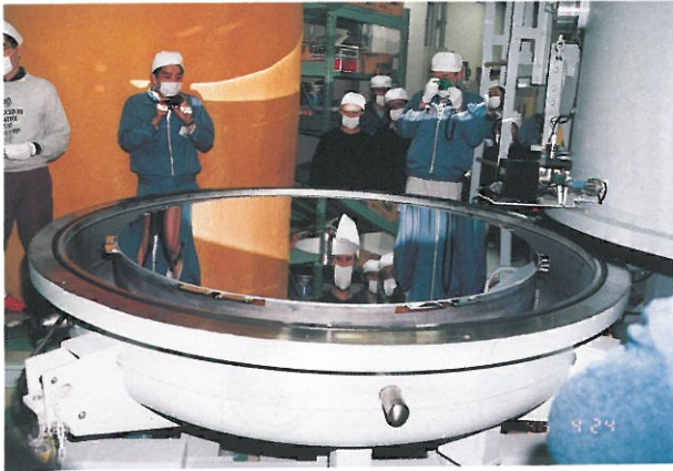
図4 アルミのコーティングを施された直後の赤外シミュレータの鏡材
