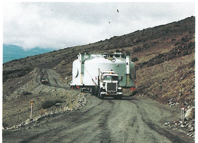
写真1 マウナケア山頂へ搬送される大型真空蒸着装置の上釜。8m主鏡の鏡面を純アルミニウム真空蒸着により形成する装置。
