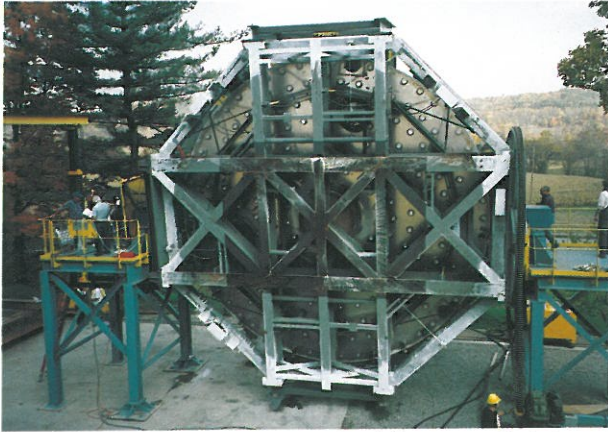
写真2 コントラベス社ワンパン工場（ビッツバーグ）において最後の反転プロセス中の8m主鏡。点々と見えるのは、261個の能動支持装置のためのスリーブ穴。
