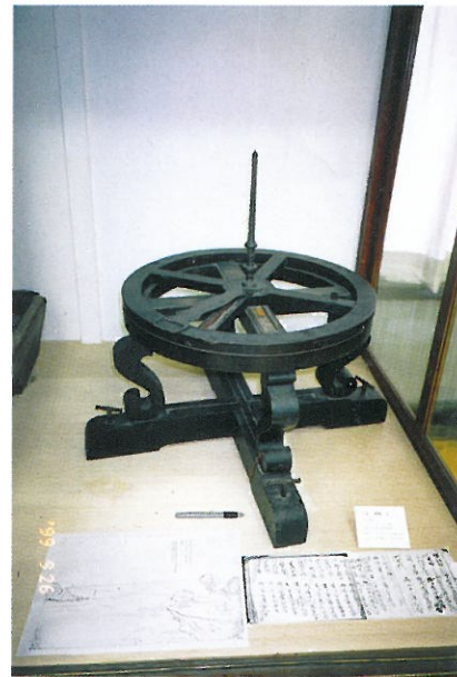
図2. 通賢製作の地平儀(文化三年). 形は中国の『靈台儀象志』所載の地平儀に一見よく似ているが、視準方法、副尺ともに全く異なる。
