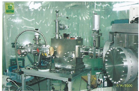
図 8. X 線望遠鏡キャリブレーション用 X 線光源とモノクロメーター。
