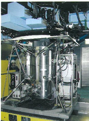
図1. すばるカセグレン焦点に取り付けられようとしているCIAO。観測装置自動交換器によって持ち上げられる。
