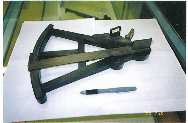
図1. 久米通賢製作のオクタント. 指度棒の上には、「オクタントフ」と書かれている。
