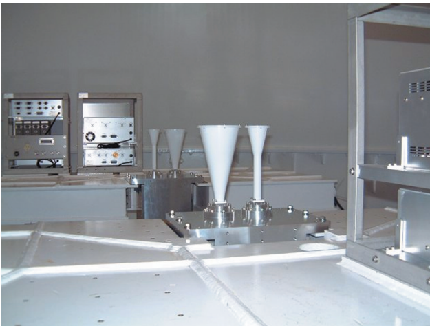
図3. プラットホーム上に搭載された2ビーム受信機. それぞれの受信機は22GHzの2つのホーンを持つ.
