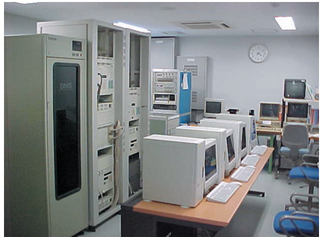
図4. 観測棟のバックエンド室に搬入された, デジタルバックエンドと制御用PC.
