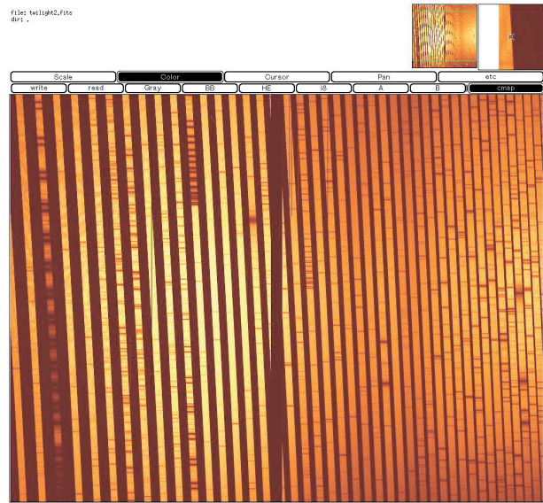
図2. 薄明光のスペクトル。図の上下が主分散方向で、右下が短波長、左上が長波長である。
