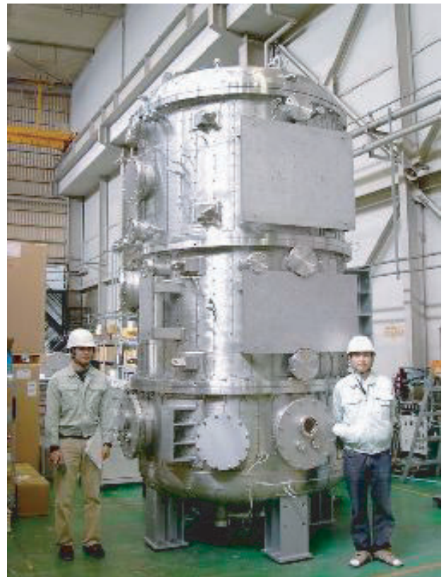
図8. 熱光学試験真空チャンバー
