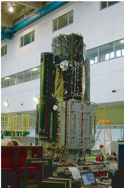
図2. 宇宙科学研究所の振動試験設備に据え付けられたSolar-B 構造試験モデル
