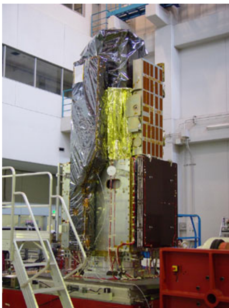
宇宙科学研究所・環境試験棟の振動試験設備に設置された Solar-B 構造試験モデル。ロケットの打ち上げ環境に対する Solar-B 衛星の構造的な健全性が確認された。
