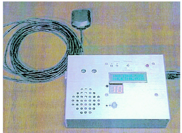
図 1. マイコン GHS 時計製作例
