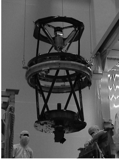
図1. 初期光学性能評価が終わり、熱実装、外套取り付けのため組立・試験タワーより取り出されるOTA (国立天文台・高度環境試験棟クリーンルーム)
