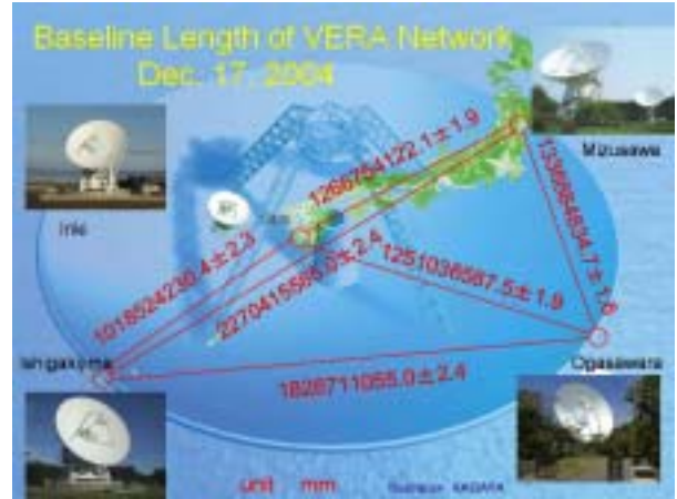
図 1. 2004 年 12 月 17 日の観測から得られた VERA 4 局間の基線長(速報値)。プレート運動の速度が年間 60mm を超える局もあり、基線長は時々変化する。
